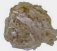
2. Desgomado por ebullición en \text{Na}_2\text{CO}_3 0,02N
